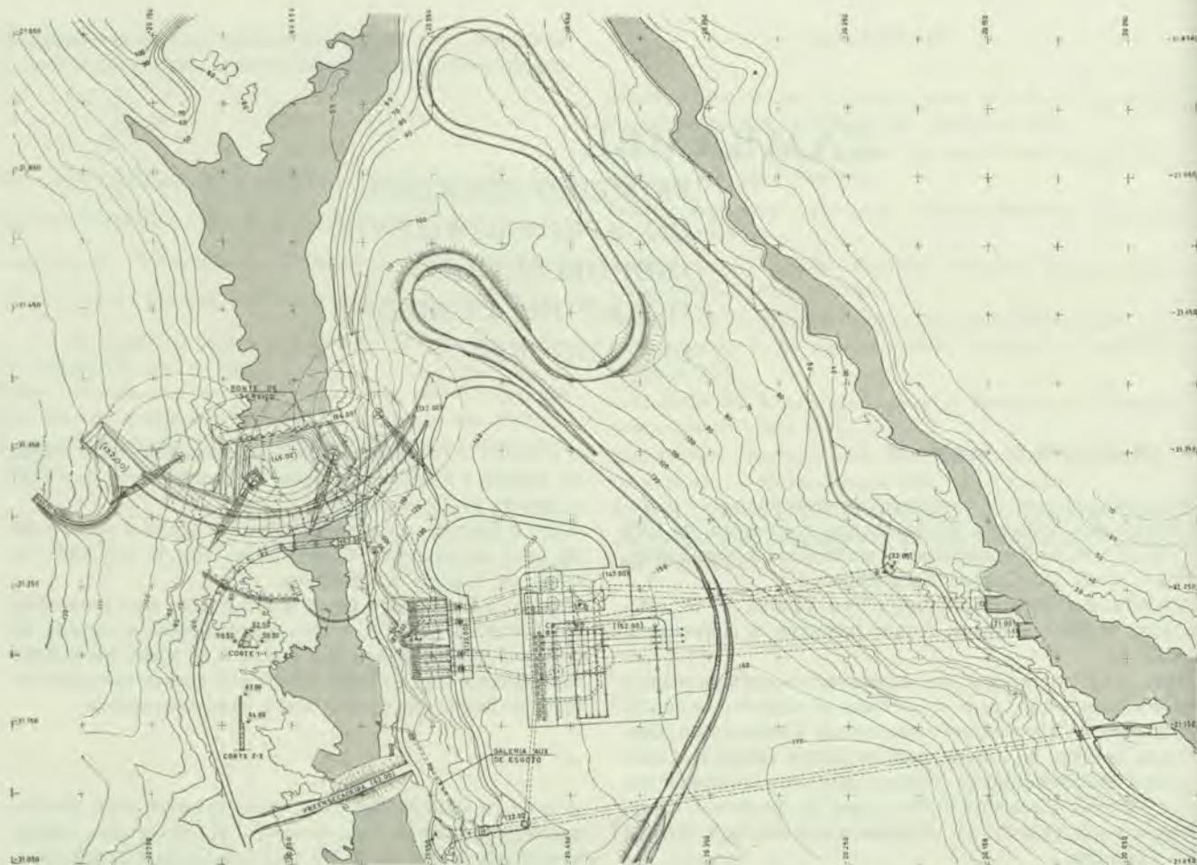
Fig. 33 — Estaleiro de Cambambe. Acesso à barragem e central. Obras de derivação, «derricks» e ponte de serviço
