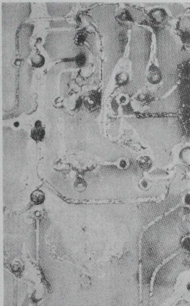
Fenómenos de corrosão do ácido clorídrico sobre um circuito impresso (o cloreto de cobre higroscópico espalha-se e forma derivações para a corrente)
