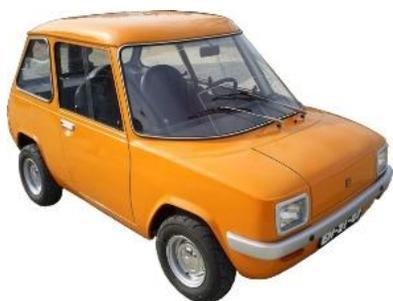
O modelo Enfield 8000, conhecido também por *E8000ECC* ou *Electric City Car*, foi fabricado no Reino Unido, pela empresa Enfield Automotive, para ser um pequeno veículo de cidade, com um motor elétrico de 6kW (8CV), capaz de atingir uma velocidade de 64 Km/h.
