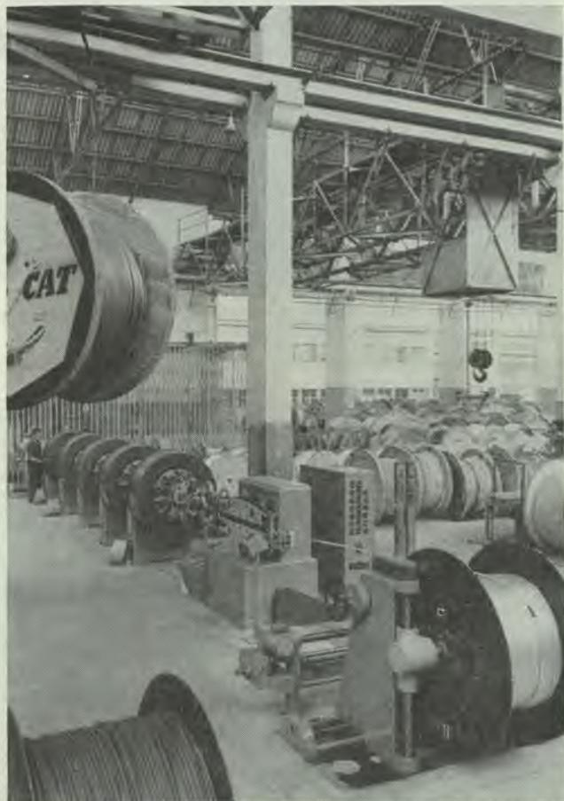
Fig. 2 — Máquina de isolar a papel condutores de cabos de potência até 30 kV equipada com 5 cabeças de alta precisão
