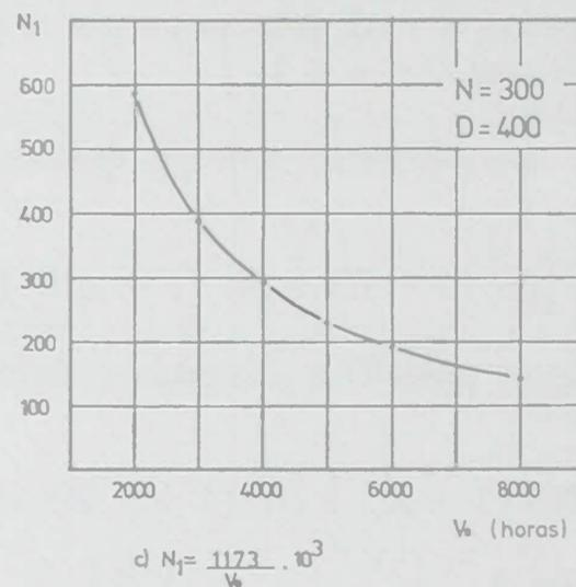
Fig. 6 — Número médio de lâmpadas substituídas por ano na política 1 em função
