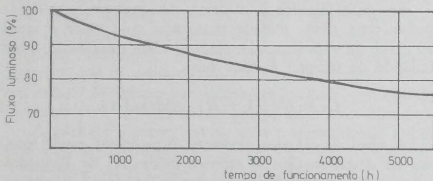
Fig. 1 — Fluxo luminoso em função do tempo de funcionamento
