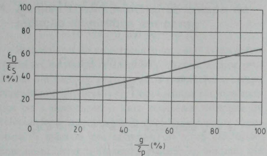
Fig. 8 — Comparação do fluxo de dispersão entre uma máquina de simples e duplo estator
