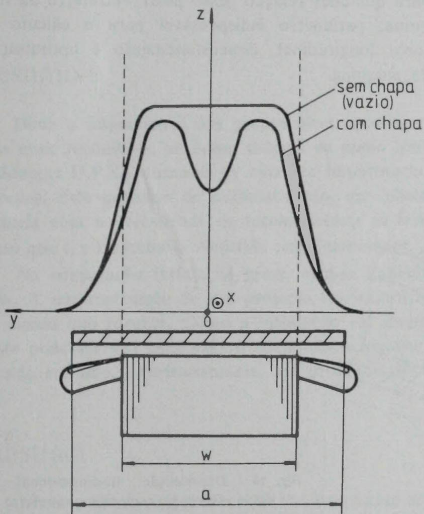
Fig. 11 — Distribuição transversal do campo de indução em carga e em vazio
