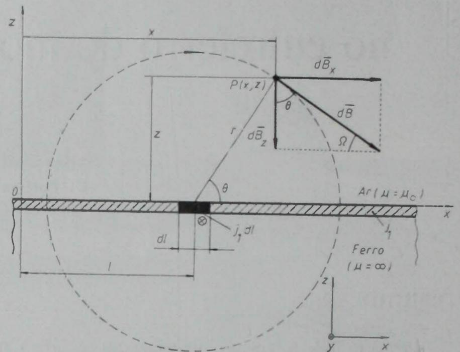
Fig. 2 — Componentes do campo de indução magnética devido a um elemento de corrente  $j_l dl$
