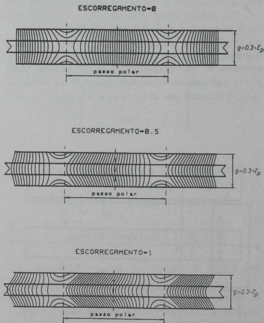
Fig. 10 — Distribuição do campo de indução magnética em carga para vários escorregamentos
