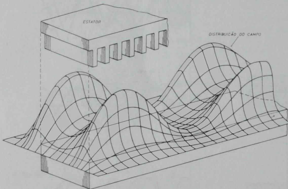
Fig. 14 — Distribuição tri-dimensional do valor eficaz do campo no entreferro
