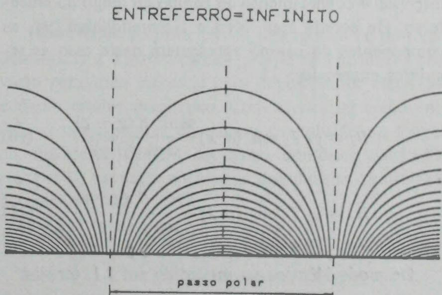
Fig. 4 — Distribuição do campo magnético de indução em vazio num simples estator eléctrico
