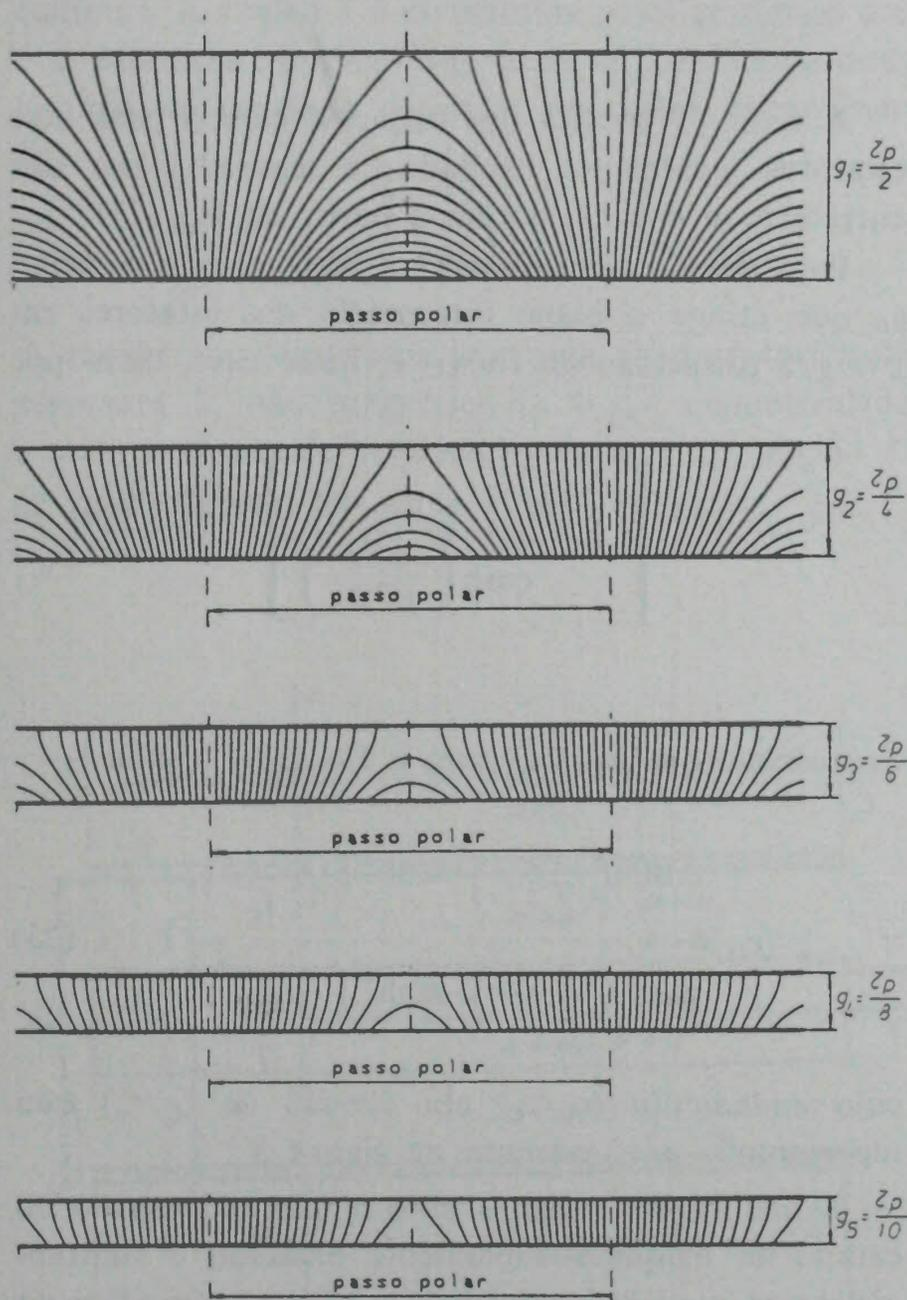
Fig. 5 — Distribuição do campo magnético de indução em vazio para várias razões passo polar/entreferro
