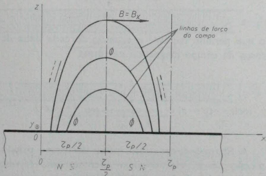
Fig. 3 — Linhas de força do campo de indução magnética ao longo de um passo polar
