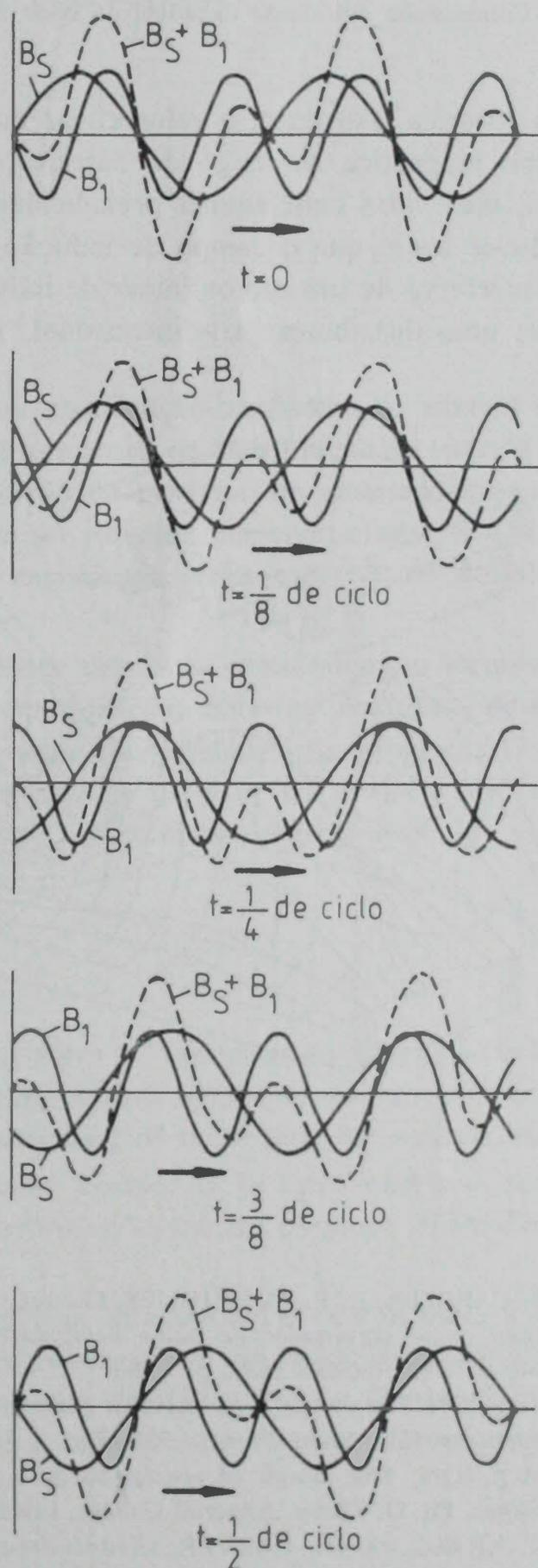
Fig. 12 — Ondas viajantes incidente, reflectida e resultante ao longo de meio ciclo
