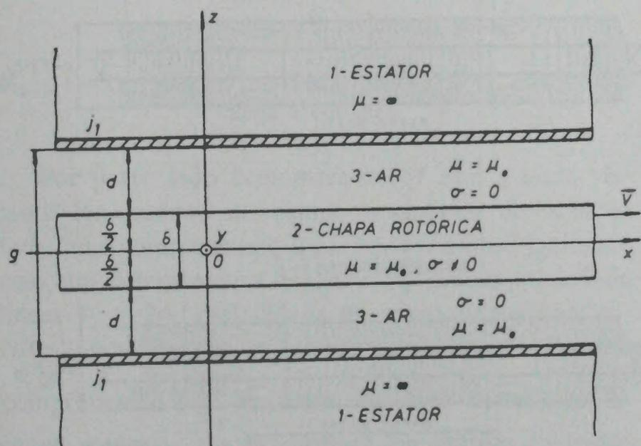
Fig. 9 — Modelo da máquina linear para o estudo do campo magnético em carga
