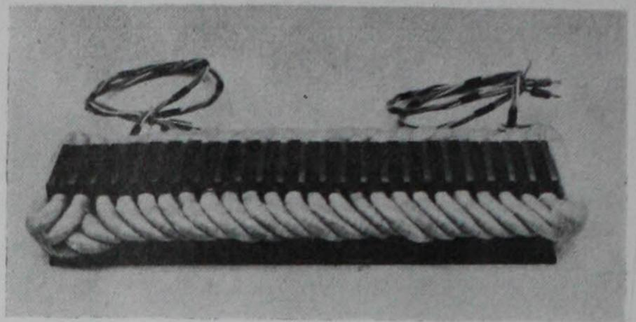
Fig. 1 — Protótipo de um motor linear de indução trifásico
