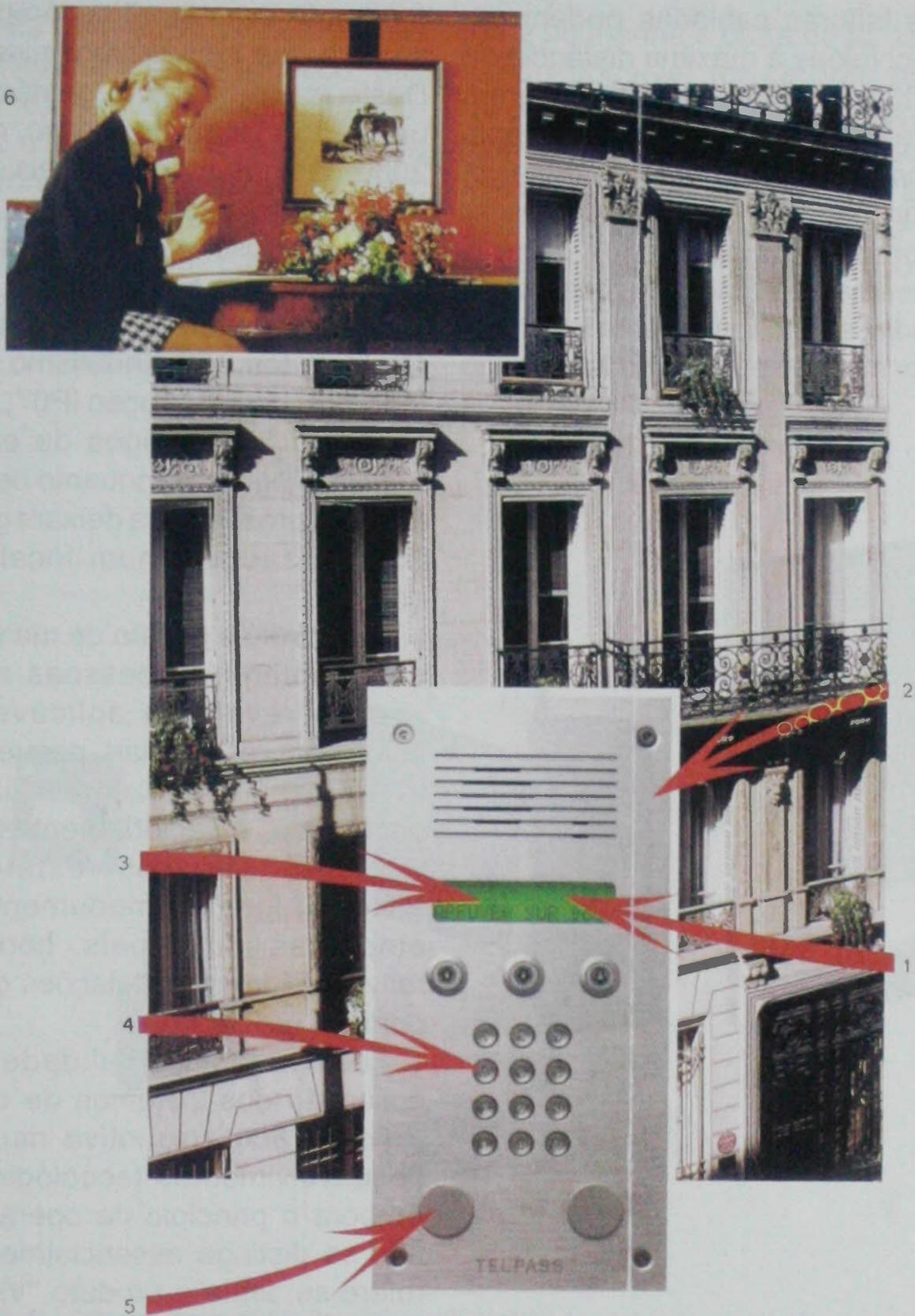
Fig. 2 - Interfonia para edifícios de escritórios ("Telepass" de Cofrel): 1 - ecrã de duas linhas, 2 - tampa anti-vandalismo em alumínio de 4 mm, 3 - ecrã retro-iluminado, 4 - teclas luminosas, 5 - reserva para os serviços da PT e controlo de acesso, 6 - atendimento do acesso pelo telefone.
