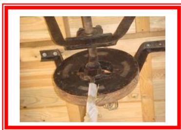
*Sistema de acionamento de Bomba de água de refrigeração*
