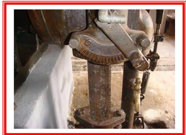
*Pormenores do dispositivo de regulação da velocidade e da válvula de entrada do ar de combustão.*
