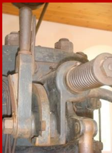
Dispositivo manual de arranque, injetor de combustível, e tanque de óleo de lubrificação
