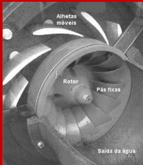
Turbina com as alhetas móveis abertas (caudal máximo)
