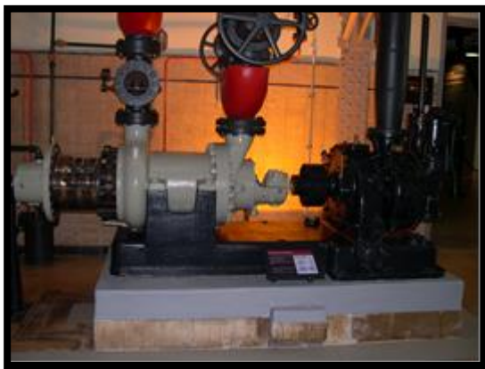
Turbobomba de água de alimentação
