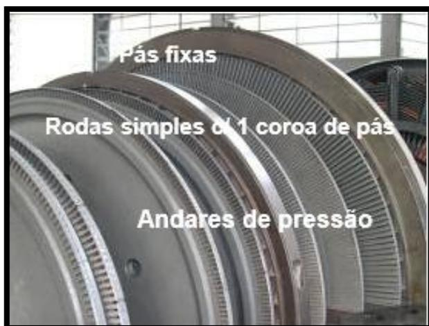
*Rotor da turbina*
