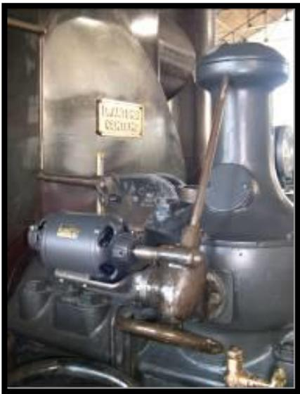
*Dispositivo de arranque da turbina*
