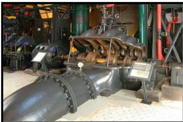
*Bomba de refrigeração do condensador*
