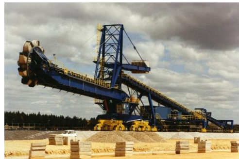
Máquina combinada de empilhamento e retoma do carvão instalada no Parque do Carvão da Central do Pego, 30 de junho de 1992. (Álbum 12951 _ 98)
