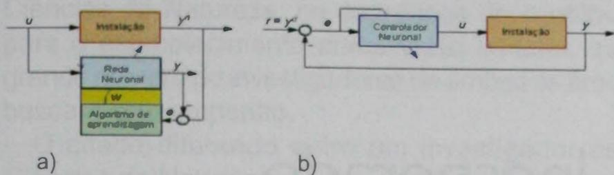
**Fig. 5 - Esquema básico de um sistema de controlo neuronal.**
