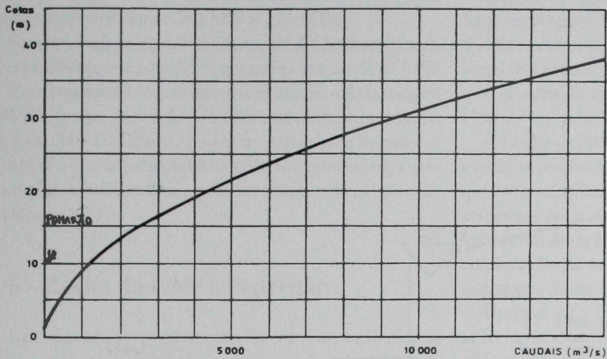
Fig. 6 - Rocha da Galé. Curva de vazão.
